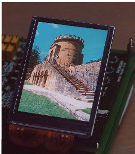
Рисунок 6 — OLED дисплей с 3,5-дюймовой QVGA-панелью
