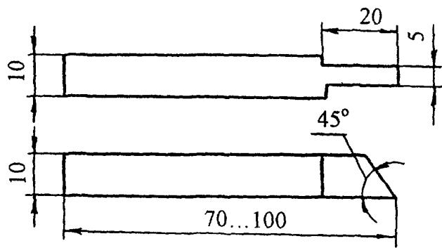
Рисунок 2 - Боек для изготовления искусственных дефектов типа зарубок
