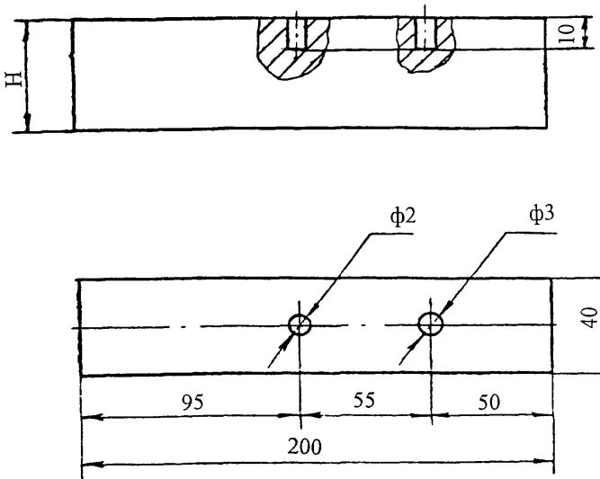
H - глубина прозвучивания (толщина контролируемой детали)
