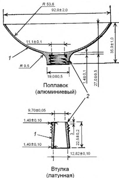
Масса поплавка:  $37,90 \pm 0,20$  г
