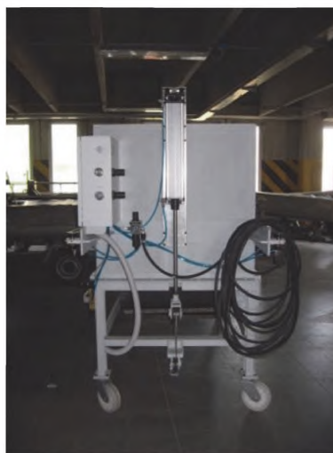
Рисунок 5 – Боковой вид аппарата для определения степени сводообразования сыпучего материала
