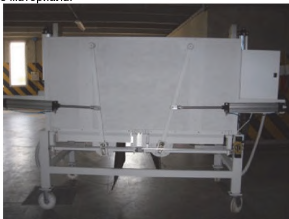
Рисунок 3 – Фронтальный вид аппарата для определения степени сводообразования сыпучего материала
