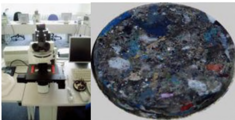
Рисунок 16 — Продвинутый микроскопический анализатор состава топлива
