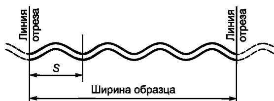
Рисунок 19 — Схема обрезки целых листов перед испытанием
