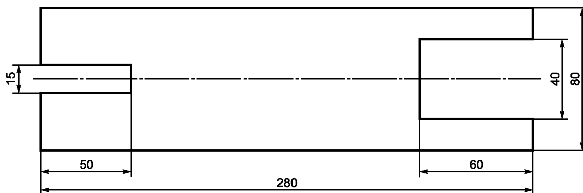
в) Стальная пластина (толщина пластины 6 мм)
