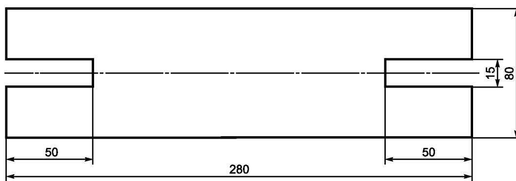
в) Стальная пластина (толщина пластины 6 мм)
