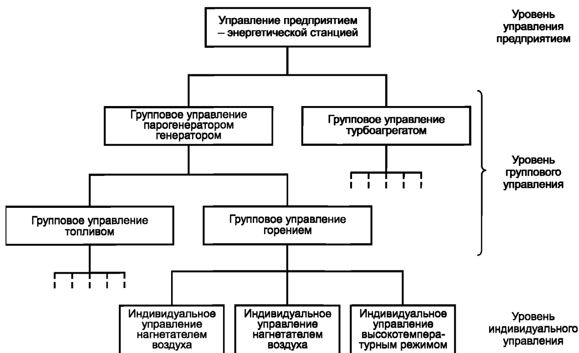
Рисунок А.6 — Уровни управления энергетической станцией (ТЭЦ)
