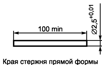
Рисунок 105 — Калибр (в виде металлического стержня) для проверки пазов, отверстий и обратных конусов
