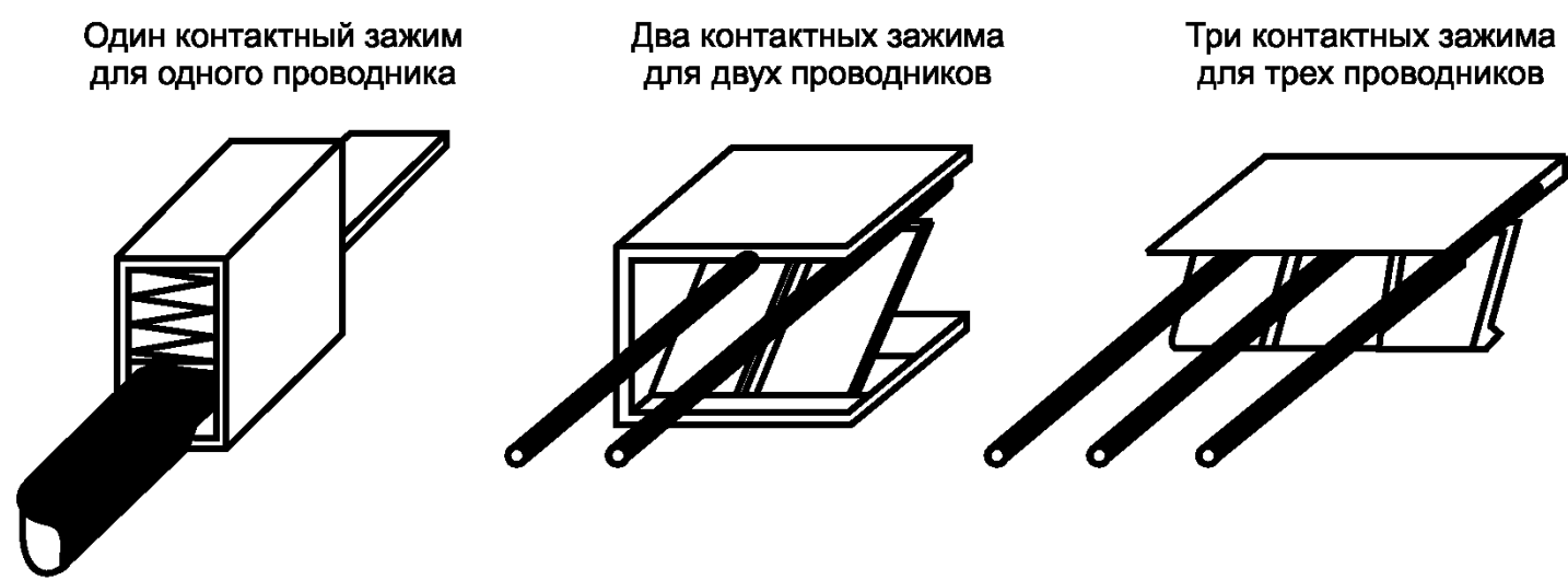
Рисунок F.6 — Примеры безвинтовых контактных зажимов
