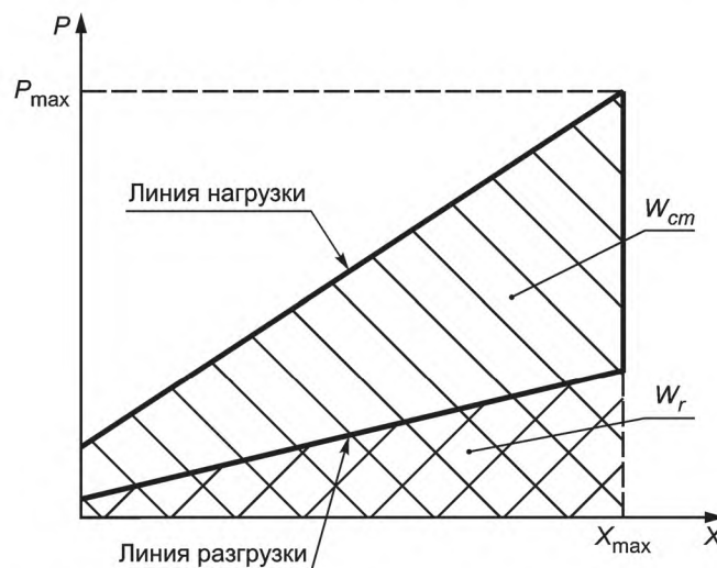
Рисунок Е.1 — Энергоёмкость на графике силовой характеристики
