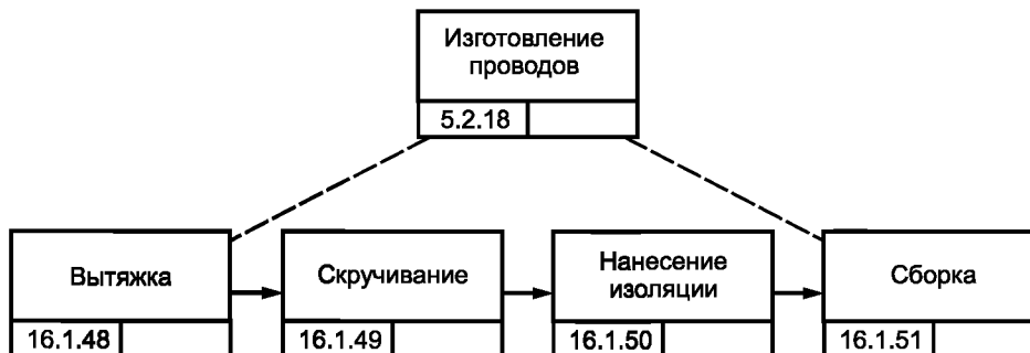
Рисунок В.6 — Процесс изготовления проводов изделия GT-350
