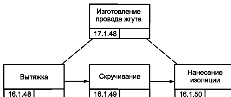
Рисунок В.5 — Процесс изготовления провода жгута
