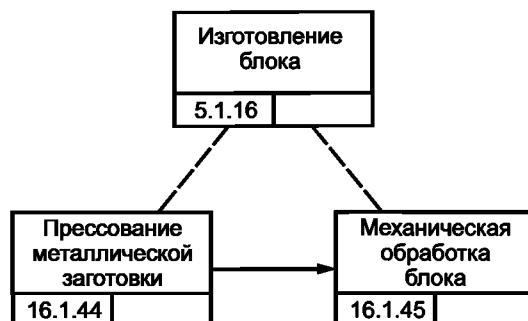
Рисунок В.3 — Процесс изготовления блока изделия GT-350
