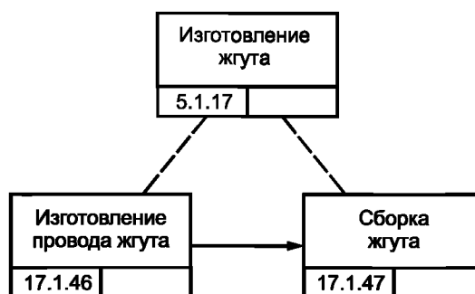
Рисунок В.4 — Процесс изготовления жгута изделия GT-350 [4]
