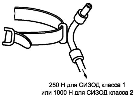
Рисунок 6 — Схема испытания прочности шланга подачи воздуха
