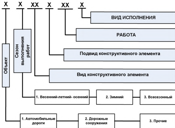
Рисунок 4.1 Структурная схема кода работы по содержанию автомобильной дороги или дорожного сооружения
