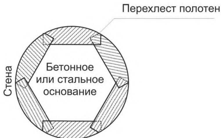
Рисунок А.1 – Укладка стеклнного мата первого слоя в примыканиях
