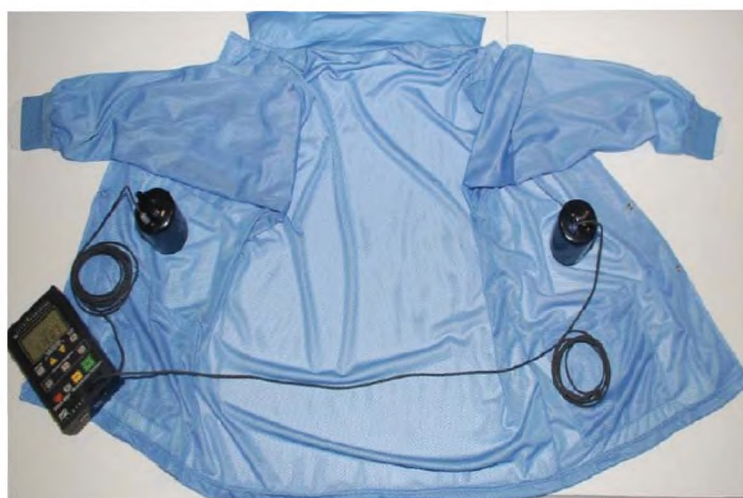
Рисунок 3 — Испытательная сборка — сопротивление «от точки до точки» (процедура «панель-панель» с использованием изолирующей поверхности)
