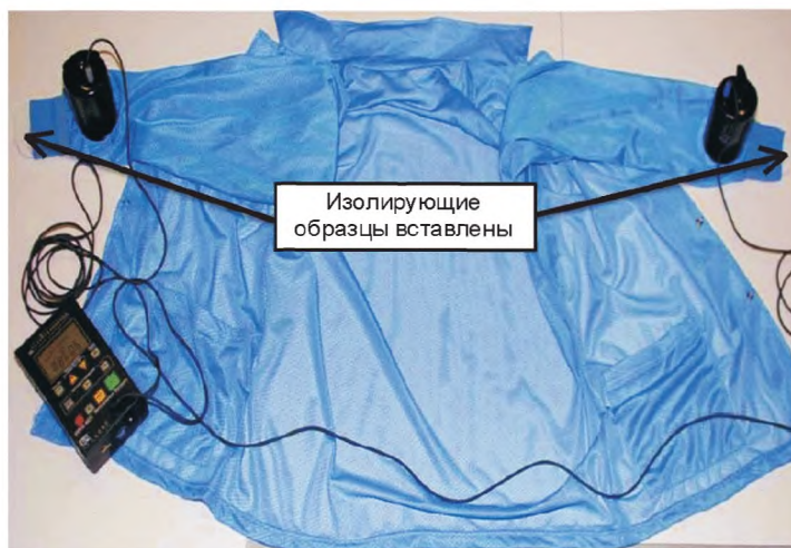
Рисунок 1 — Испытательная сборка — сопротивление «от точки до точки» (процедура «рукав-рукав» с использованием изолирующих вкладок)
