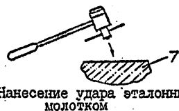
Нанесение удара обычным молотком по головке эталонного молотка
