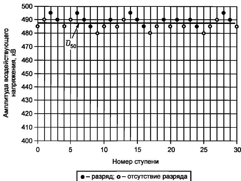
Рисунок А.3 — Результаты испытаний изоляции методом «вверх-вниз» (метод А.2.2)
