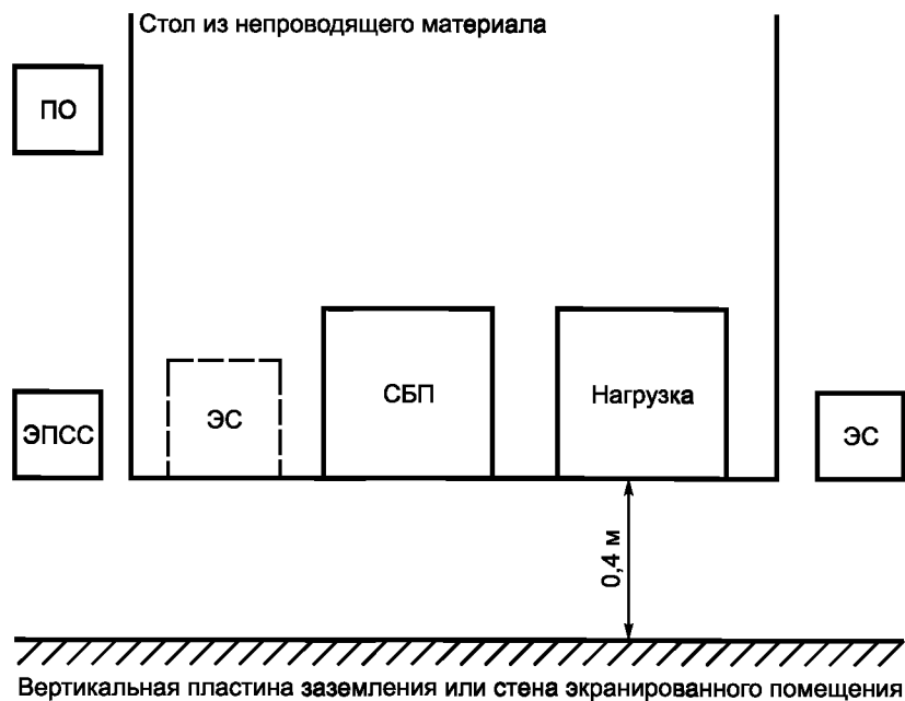
Рисунок А.6 — Размещение испытуемых СБП (настольное оборудование, измерение напряжения ИРП); вид сверху
