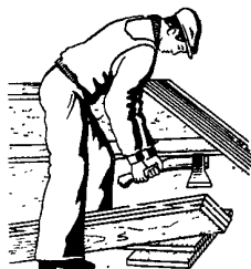
Рис. 90. Вырубка сопряжений фризовых досок в накладку "на ус"
