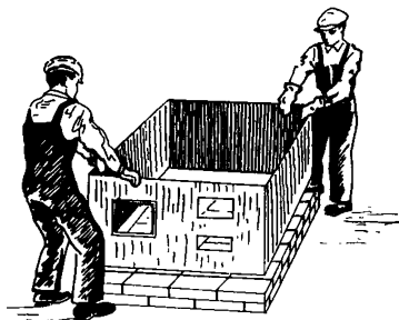
Рис. 106. Установка первого става
