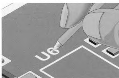
Рисунок 7 с – Нанесение маркировки палочкой, смоченной эпоксидным составом
