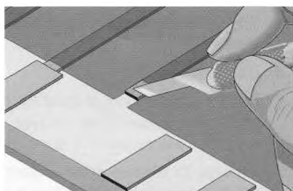
Рисунок 35 а – Удаление поврежденного концевого контакта
