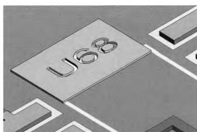
Рисунок 7 б – Нанесение маркировки через трафарет
