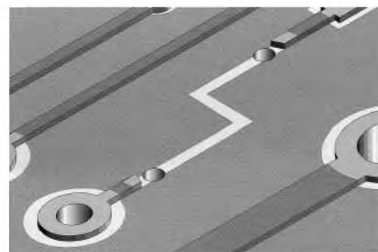
Рисунок 22 b – Сверление сквозных отверстий рядом с проводником
