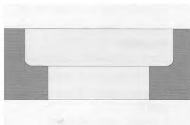
Рисунок 10 с – Создание уступа в кромке печатной платы
