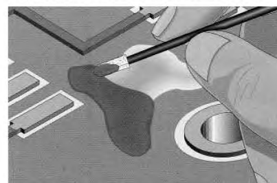
Рисунок 9 д – Создание текстуры поверхности пористым тампоном
