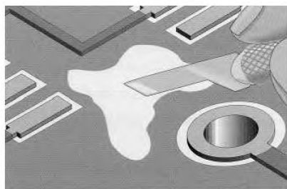
Рисунок 9 а – Удаление поврежденного материала
