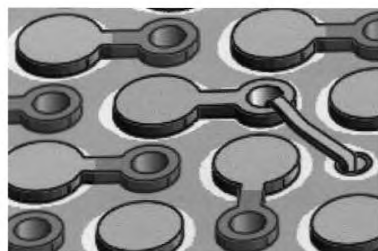
Рисунок 44 б – Установка медной перемычки из фольги в тефлоновую трубку и металлизированное отверстие
