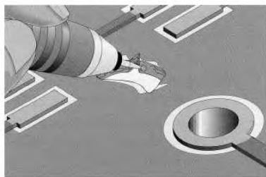
Рисунок 10 а – Удаление поврежденного материала фрезой
