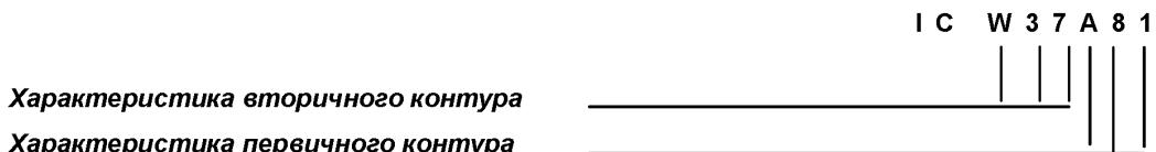
В этом издании стандарта предусмотрено по возможности упрощенное обозначение путем пропуска в обозначении буквы А и цифры 7 при определенных условиях перемещения вторичного хладагента.
