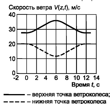
Рисунок 9 — Пример скоростей ветра в верхней и нижней точках ветроколеса
