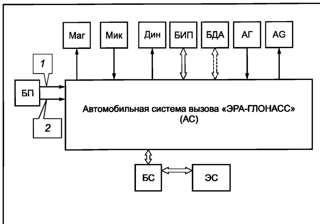
Маг — магнитола АТС; Мик — микрофон; Дин — динамик; БИП — блок интерфейса пользователя; БДА — блок датчика аварии; АГ — антенна ГЛОНАСС; AG — антенна GSM/UMTS; БП — блок питания (12/24 В); БС — блок сопряжения; ЭС — эмулятор системы «ЭРА-ГЛОНАСС»; 1 — кабель питания; 2 — цепь зажигания
