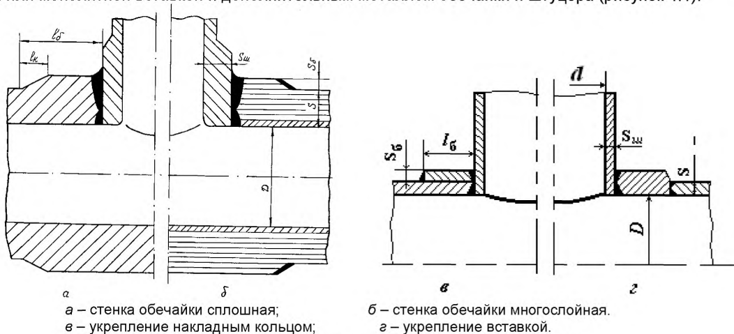
Рисунок 4.1 – Способы укрепления отверстий в обечайке (днище)
