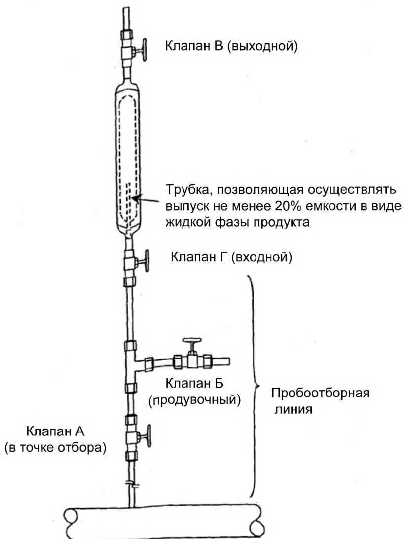
Рисунок 18 — Схема альтернативной продувки пробоотборного контейнера
