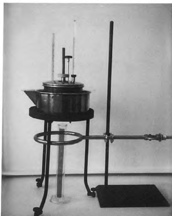
Рисунок 2 – Вискозиметр Энглера с мерным цилиндром вместимостью 50 см 3
