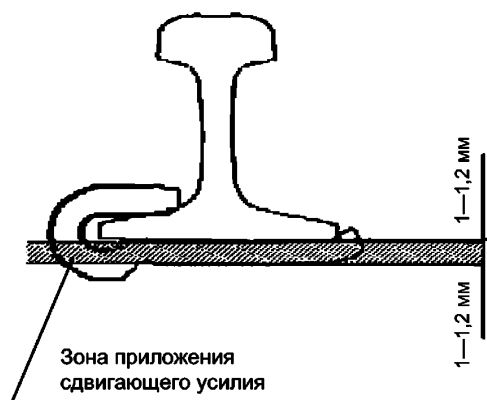
Рисунок 5 — Схема проверки удерживающей способности противоугона для железнодорожного пути на мостах
