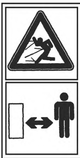
D.2 – Соблюдай безопасную дистанцию от устройства для срезания ботвы. Опасность выброса
