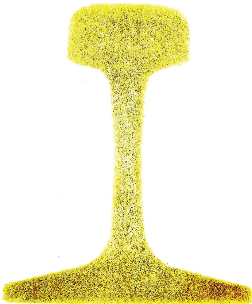
Рисунок И.1 — Макроструктура без ликвации (серный отпечаток)
