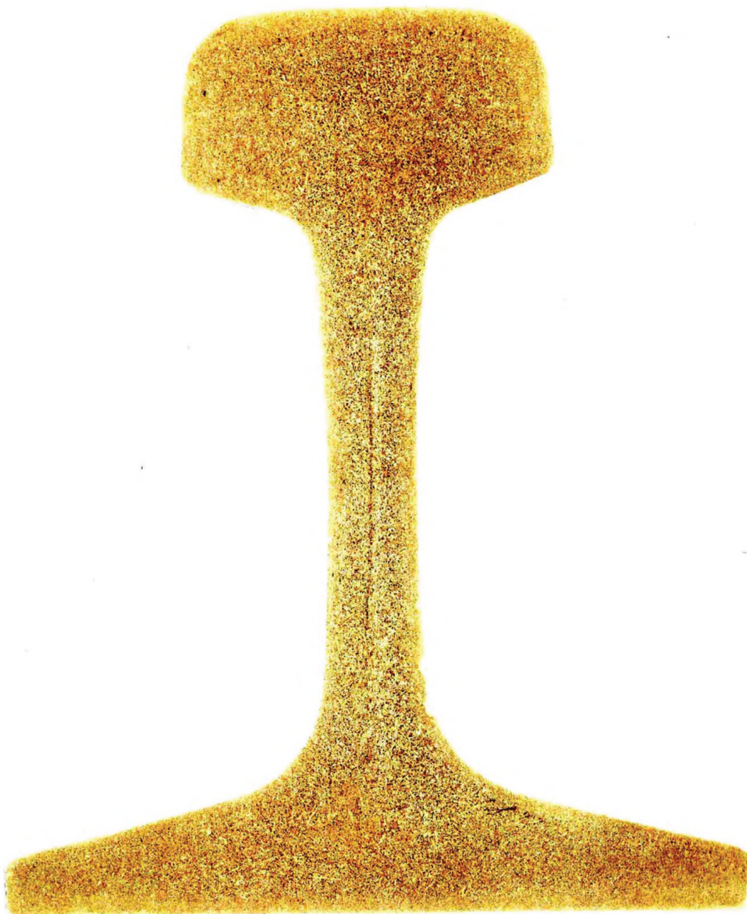
Рисунок И.13 — Ликвационные полосы (серный отпечаток)
