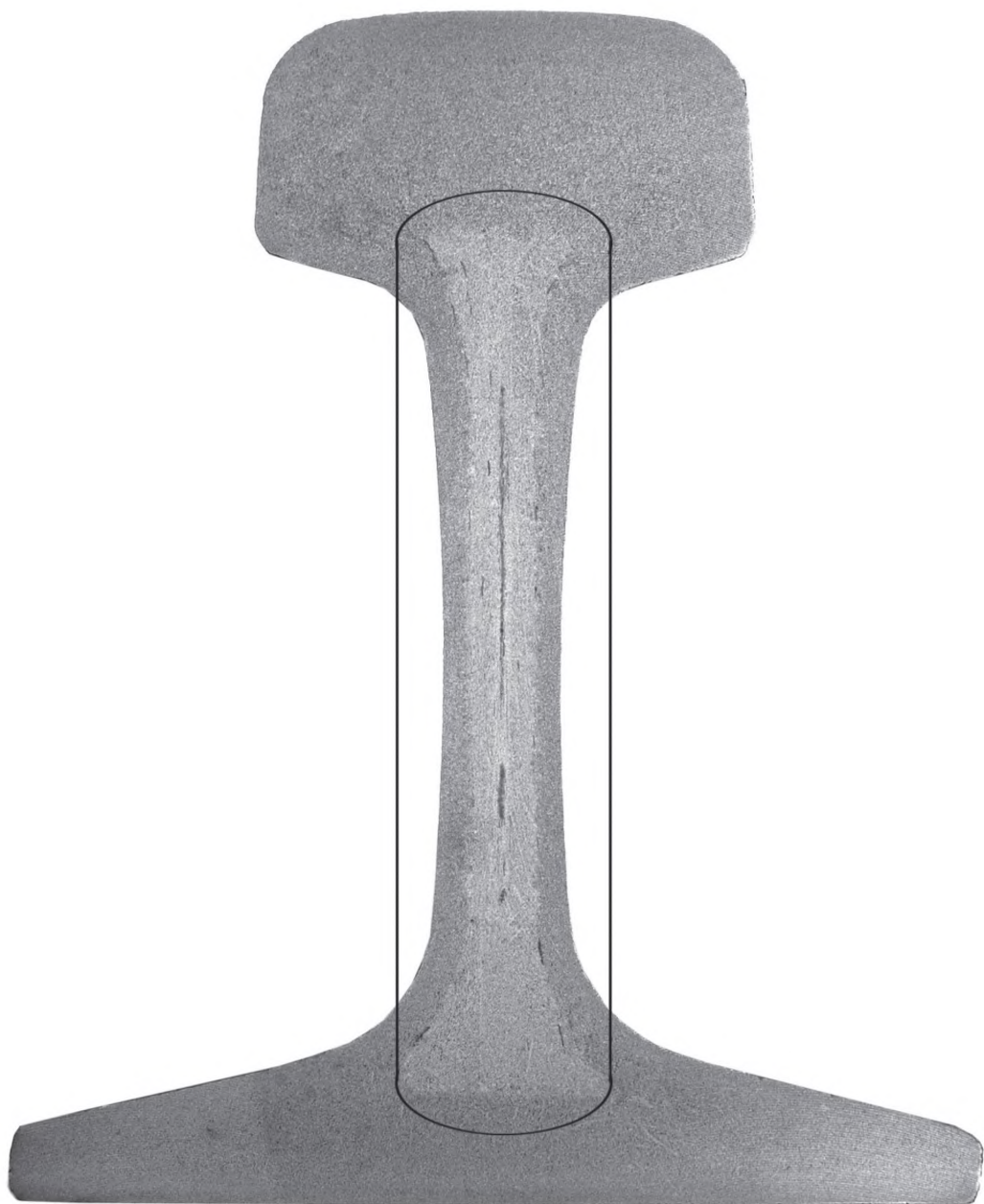
Рисунок И.7 — Ликвационная зона, имеющая ширину, превышающую \frac{1}{3} толщины шейки (глубокое травление)
