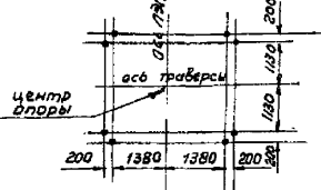
Расположение анкерных болтов фундамента.
