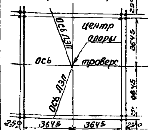
План анкеровых болтов фундамента
