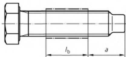
Рисунок 2 — Покрытия со специальной длиной и положением
