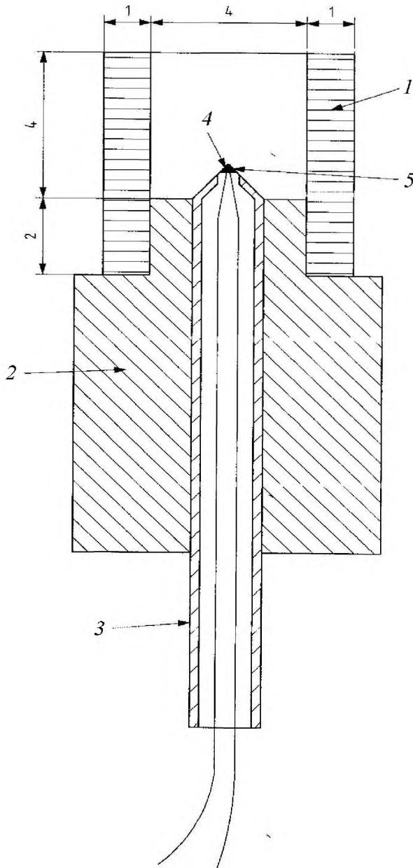
1 – полиэтиленовая трубочка; 2 – полиамидный блок; 3 – трубочка из нержавеющей стали; 4 – термопара;
