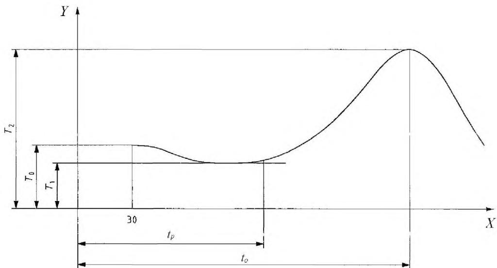
$X$  – время, с;  $Y$  – температура,  $^\circ\text{C}$ ;  $T_0$  – температура во время закладки образца;  $T_1$  – температура после небольшого снижения сразу после закладки материала;  $T_2$  – максимальная температура;  $t_p$  – время от начала смещивания до начала реакции отверждения при  $T_1$ , обозначенное как рабочее время;  $t_0$  – время от начала смещивания до времени достижения максимальной температуры, обозначенное как время отверждения
