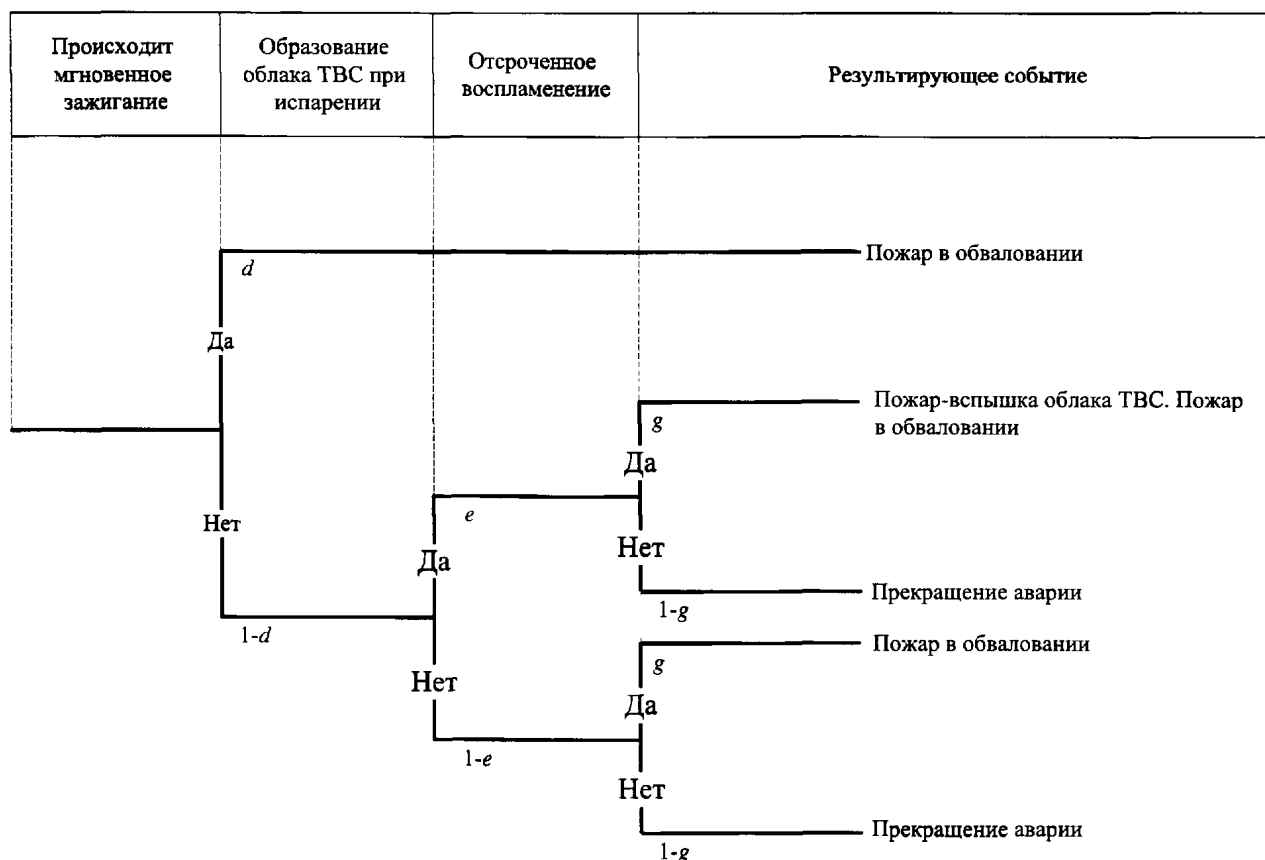
Рис. 4-4. Дерево событий разрушения/перелива подземного резервуара (сценарий A 4 )
