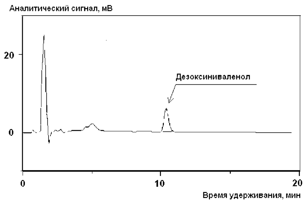
Рисунок А.1 – Пример типичной хроматограммы пробы пшеничной муки, загрязненной дезоксиниваленолом естественным путем. Содержание дезоксиниваленола около 900 мкг/кг
