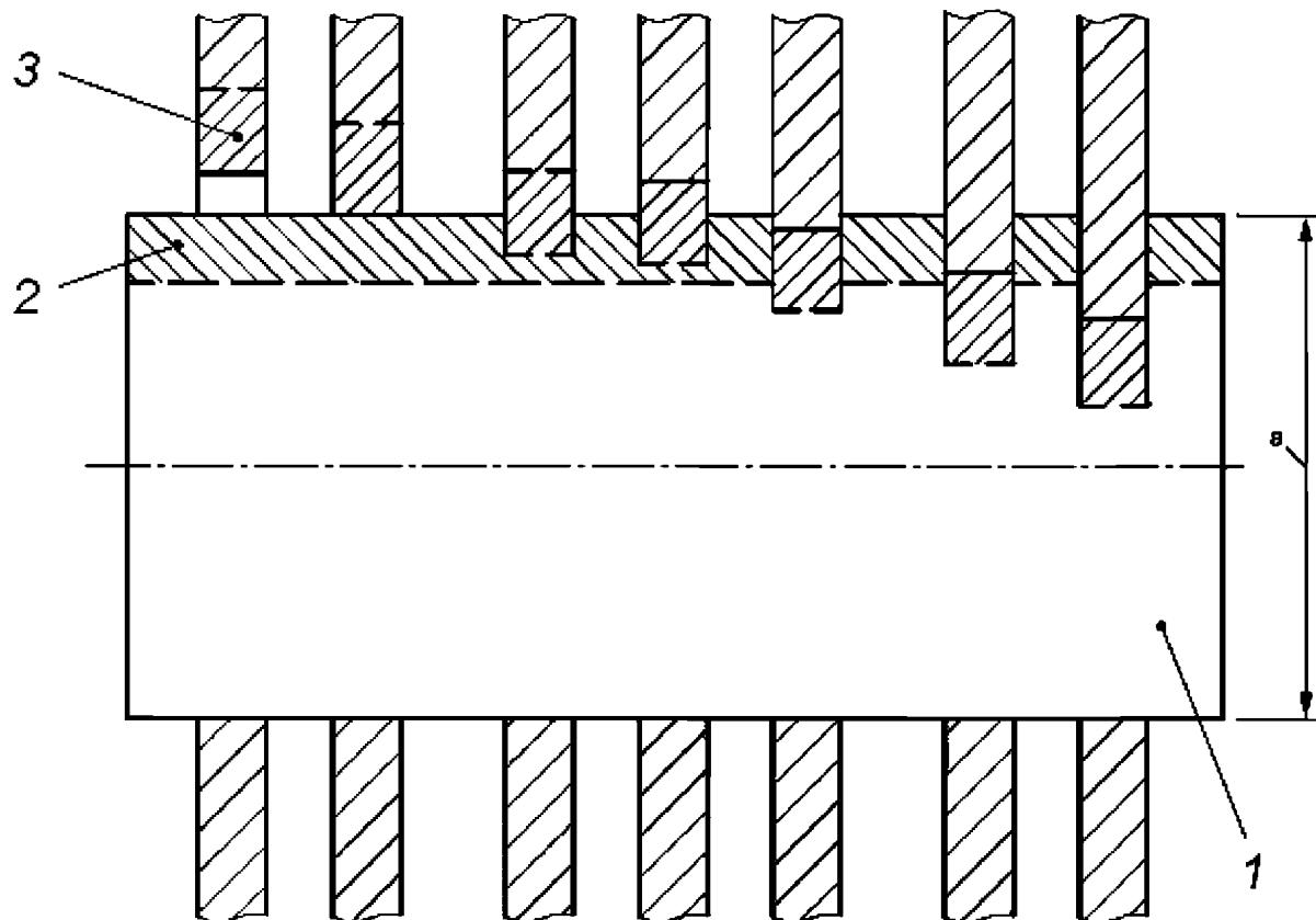
1 — основной вал; 2 — интервал допуска основного вала; 3 — интервал допуска различных отверстий;
