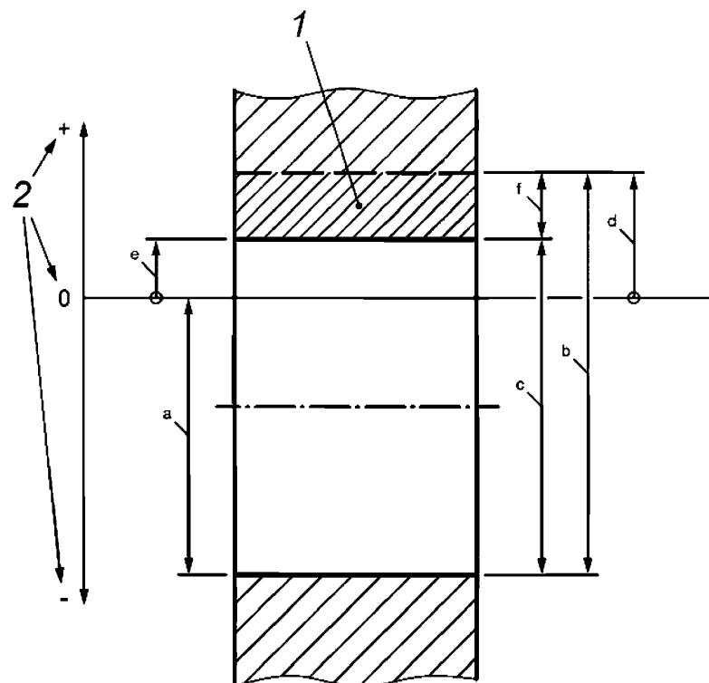
1 — интервал допуска; 2 — правило знаков для отклонений; а —名义尺寸; б — верхний предельный размер; в — нижний предельный размер; д — верхнее предельное отклонение; е — нижнее предельное отклонение (в данном случае оно является и основным отклонением); ф — допуск
