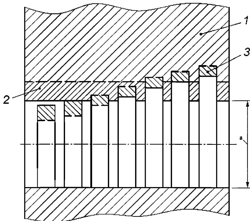
1 — деталь с основным отверстием; 2 — интервал допуска основного отверстия; 3 — интервал допуска различных валов; а —名义尺寸
