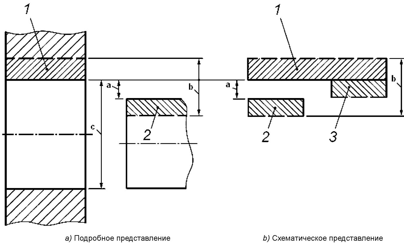
1 — интервал допуска отверстия; 2 — интервал допуска вала, случай 1: верхний предельный размер вала ниже, чем нижний предельный размер отверстия, наименьший зазор больше нуля; 3 — интервал допуска вала, случай 2: верхний предельный размер вала совпадает с нижним предельным размером отверстия, наименьший зазор равен нулю; а — наименьший зазор; б — наибольший зазор; с —名义尺寸, равный нижнему предельному размеру отверстия
