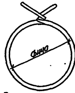
Крепление кольца воздуховода к несущему тросу с помощью скрытки
