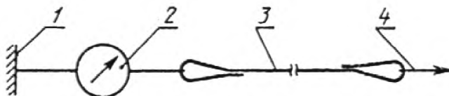
1 – жесткая опора; 2 – измеритель усилия; 3 – строп или другой элемент пояса; 4 – растягивающее усилие
