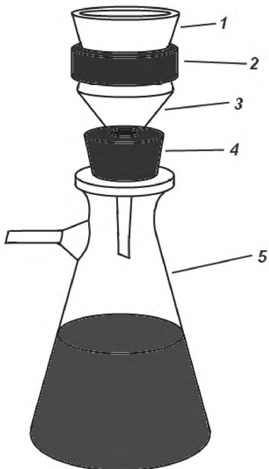
1 – тигель Гуча; 2 – резиновая соединительная трубка; 3 – фильтровальная трубка; 4 – неопреновая пробка; 5 – фильтровальная толстостенная колба
