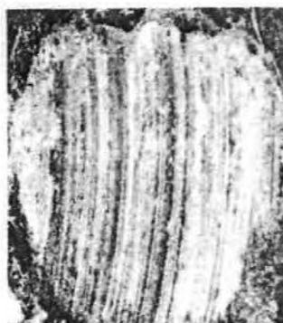
Рисунок 7 — Типичные пятна износа шарика после удаления налипшего металла
