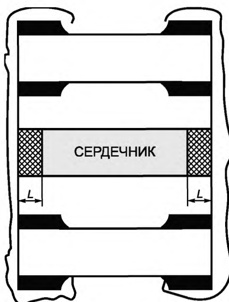
Рисунок 14 — Расположение металлического сердечника в сквозном металлизированном отверстии
