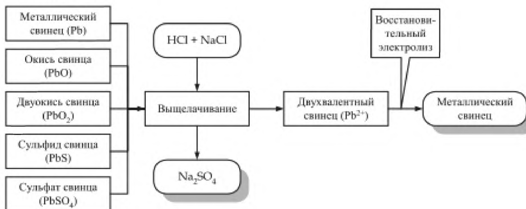
Рисунок 4 - Электрохимические процессы при гидрометаллургическом производстве свинца
