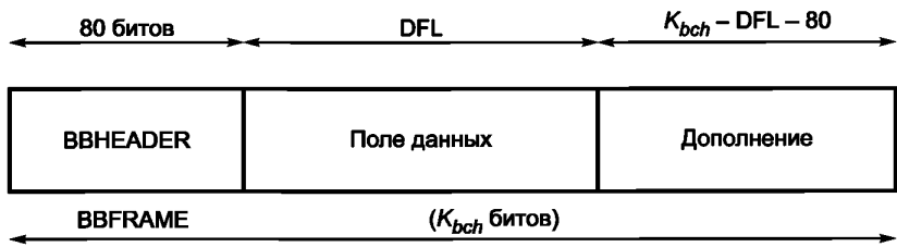
Рисунок 12 — Формат кадра BBFrame на выходе адаптера потока
