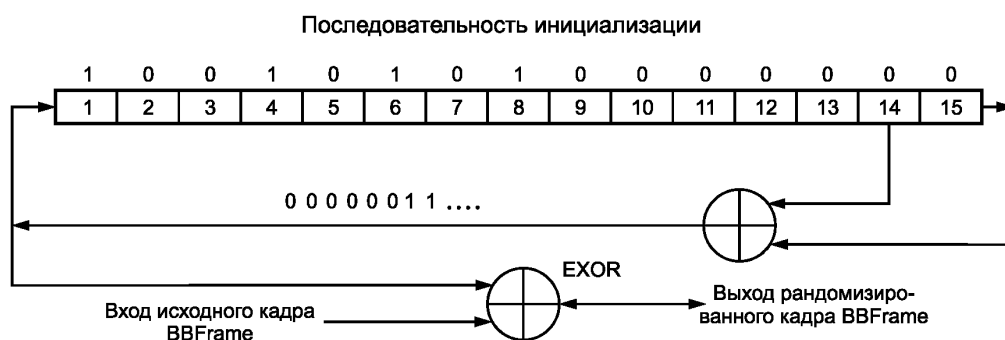
Рисунок 13 — Структурная схема возможной реализации кодера псевдослучайной последовательности
