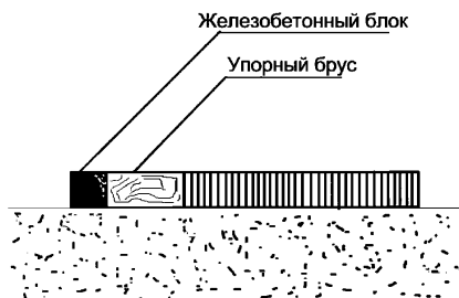
Рисунок 9.2 – Установка бруса по окончании работ
