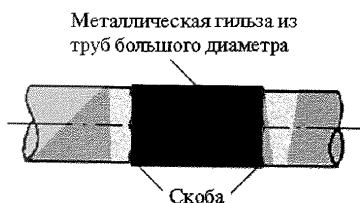
Рисунок 5.43 – Соединение стальных труб с помощью гильз
