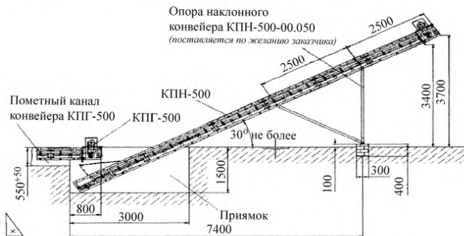
Рисунок 60 – Схема перегрузки помета с горизонтального пометоуборочного транспортера (КПГ-500) на наклонный транспортер (КПН-500)
