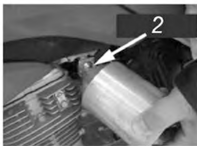
б) ручной орган управления для отключения топливоподачи
