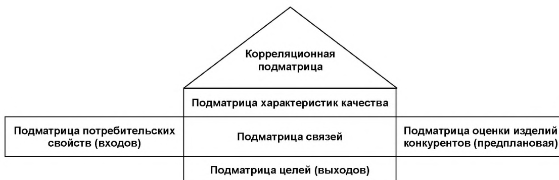
Рисунок 2 — Типовая структура матрицы СФК («дом качества»)
